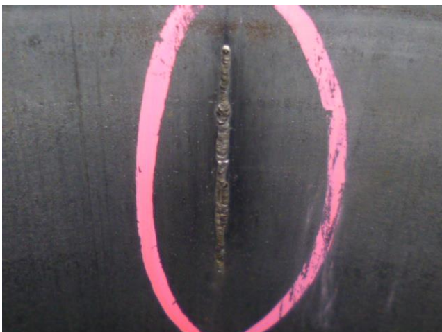
Blow by part laser welding. 吹き抜け傷部 レーザー溶接肉盛
