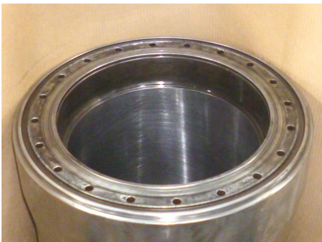
Finished liner honing. プラトーホーニング完成
