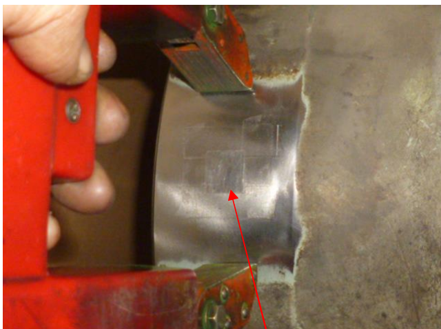
A-type test piece for check equipment. 磁気探傷検査 機材確認用 A 形標準試験片
