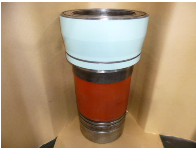
After coating. 外周塗装、完成
