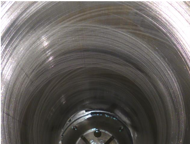
Progress of the Liner Honing. ホーニング途中
