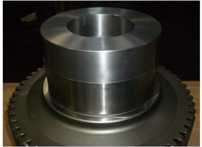
後進歯車、ディスタンス インロー部にて取り付け Reverse gear defective joint. Installed at the distance inlay.
