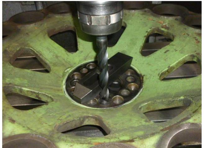
タワミ継手 取り付けボルト穴開け 6箇所 Flexible shaft coupling 6 pcs bolt holes.
