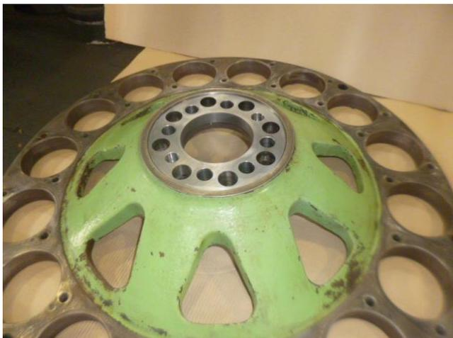
タワミ継手取り付けボルト穴及び平行ピン穴加工後
