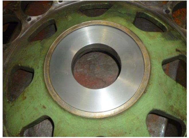
液体窒素にて冷却 Cool with liquid nitrogen. スペーサー冷やし嵌め(締め代 0.05~0.06) Cold fit.
