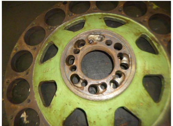
φ26 平行ピン穴及び M20 ボルト穴 全不良。Φ26 Parallel pin hole and M20 bolt hole are all defective.
