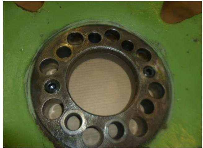
抜き出し用ネジ穴にてスペーサ固定用ネジ挿入
