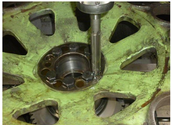
φ26リーマ穴共加工 8箇所 Reamerhole co-processing 8 places.
