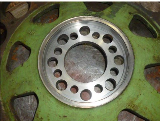
内径  $\phi 198$  継手 厚み 35t 削正 深さ 20 mm 削正
