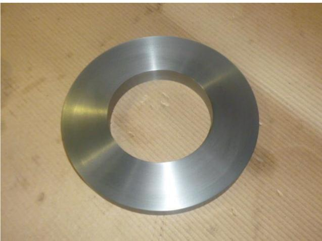
外径  $\phi 198 \times$  厚み 20t スペーサー製作。Outer diameter  $\Phi 198 \times$  thickness 20t spacer Production.
