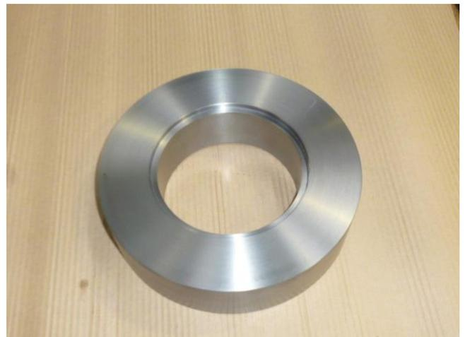
後進歯車用ディスタンス製作 Reverse gear defective joint distance Production. 裏面  $\phi 120$  インロー部加工
