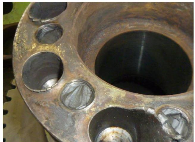
M20×1.5 ボルト全6箇所折れ込み不良
