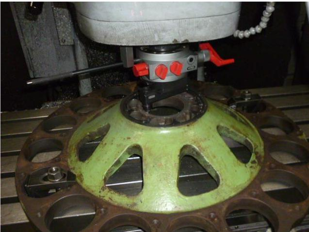
タワミ継手 合わせ面削正。Face to face Machinindo up.
