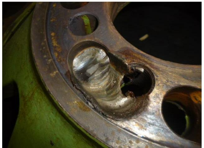
φ26 平行ピン折損。Φ26 Parallel pin Broken.
