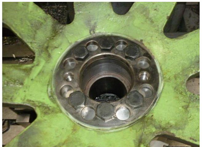
M20×1.5×60 ボルトにてタワミ継手及び後進歯車固定 Fixed as Flexible shaft coupling and Reverse gear defective joint
