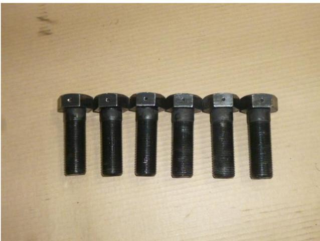
タワミ継手取り付け用ボルト 6本 6 bolts for mounting the deflection joint.
