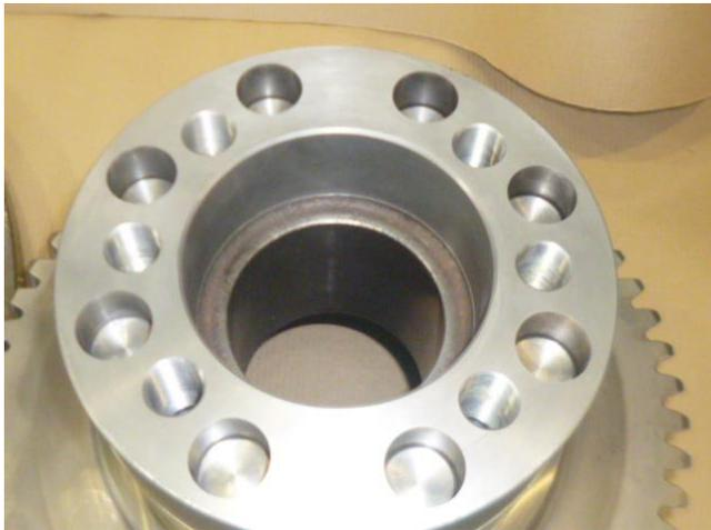
ピン挿入後、リーマ穴深さ 20 (タワミ継手取り付け用穴深さ)
