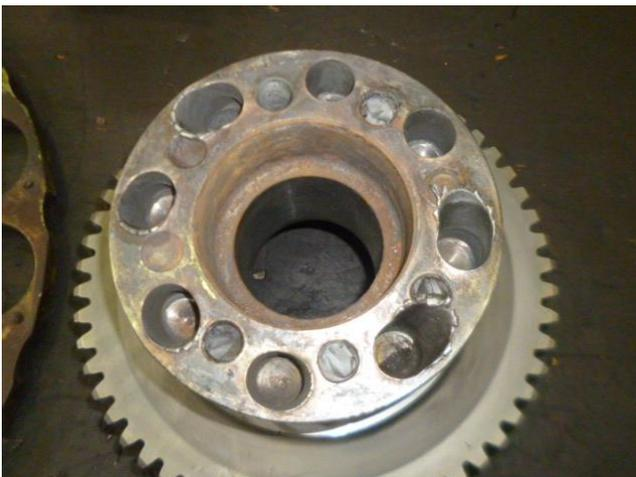
後進歯車 タワミ継手取り付け部不良
