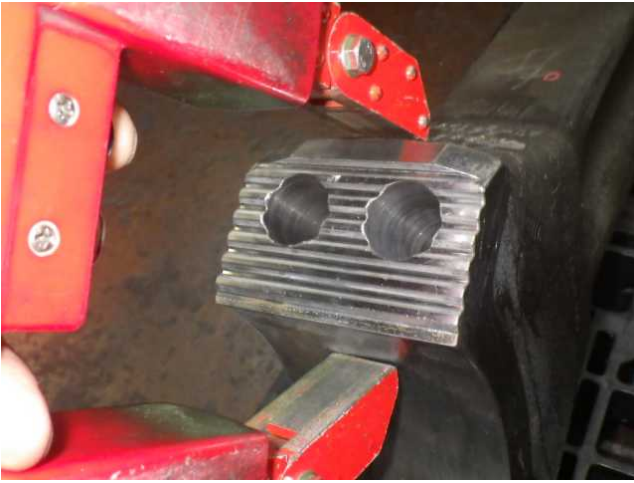
セレーション 磁気探傷検査 Magnaflux Inspection.
