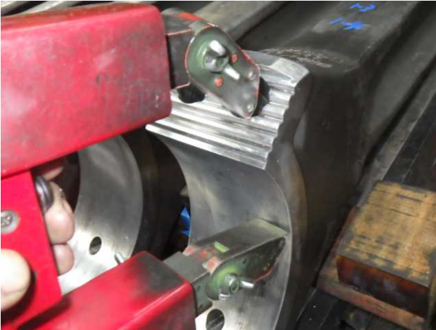
本体側メネジ 磁気探傷検査
