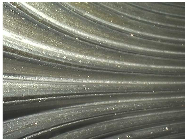
ネジ山 タッピング加工後 After screw thread tapping.
