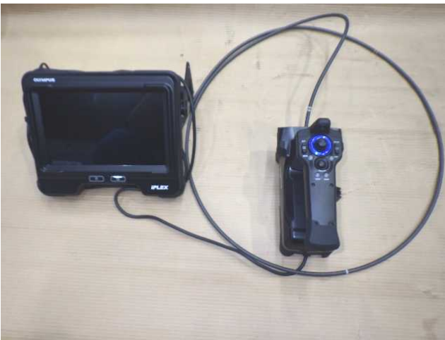
オリンパス IV9000GX SET J 先端ブラックライト装着 Olympus IPLEX GX/GT tip black light installed.
