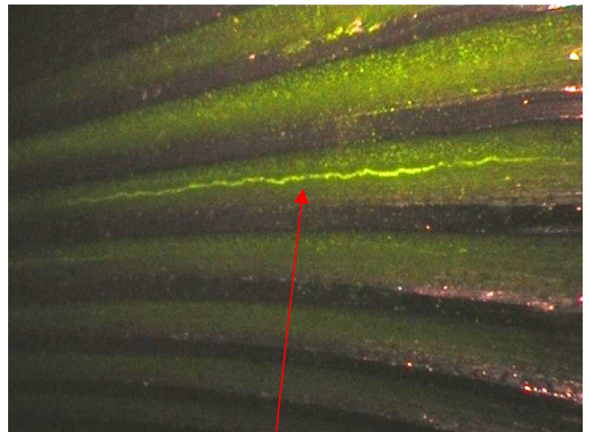
テストピース 欠陥磁粉模様確認 Found crack
