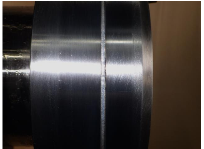
フライホイール側 オイルシール摩耗部 レーザー溶接肉盛 Flywheel side oil seal wear part laser welding.
