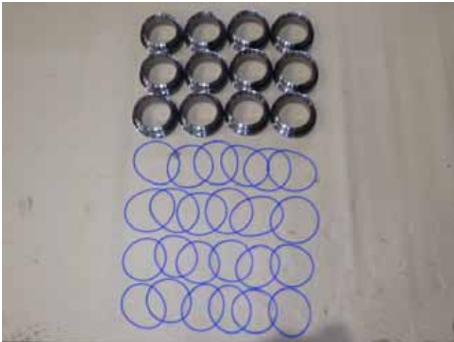
New exhaust valve seat and O-ring. 排気弁座、Oリング新品
