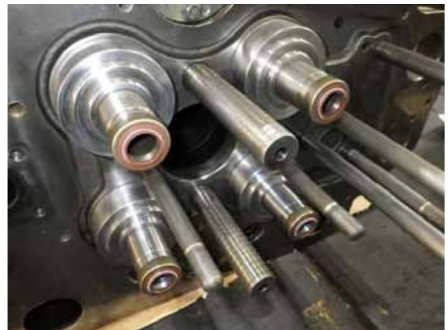
Renewed valve stem seal. バルブステムシール新替
