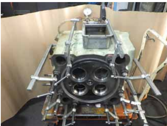
NO.3D511 Pressure test. 耐圧テスト
