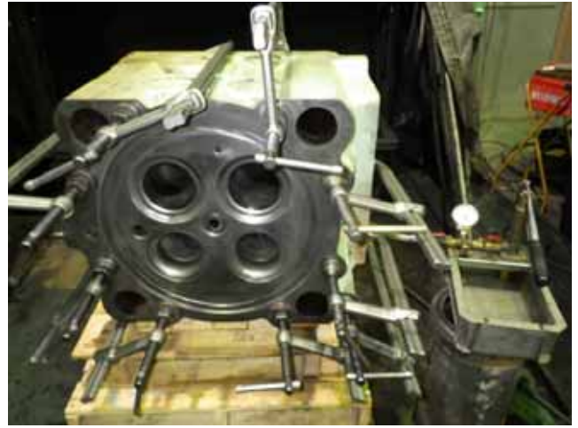
Pressure test. 耐圧テスト
