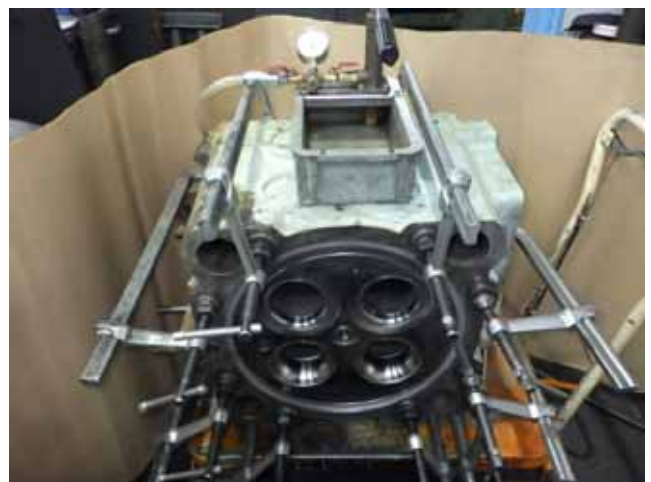
NO.3E280 Pressure test. 耐圧テスト
