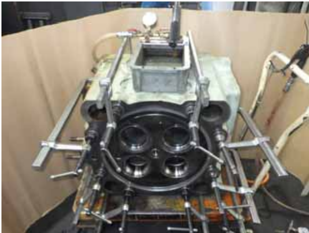
NO.3D507 Pressure test. 耐圧テスト
