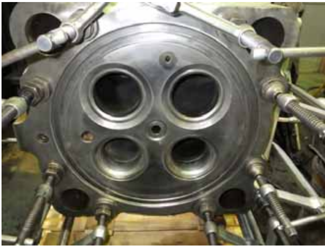
Combustion side no water leak. 燃焼面 水漏れ無し
