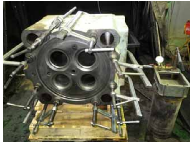
Pressure test. 耐圧テスト
