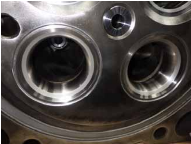
Exhaust valve seat lapping. 排気弁座 当たり面摺り合わせ
