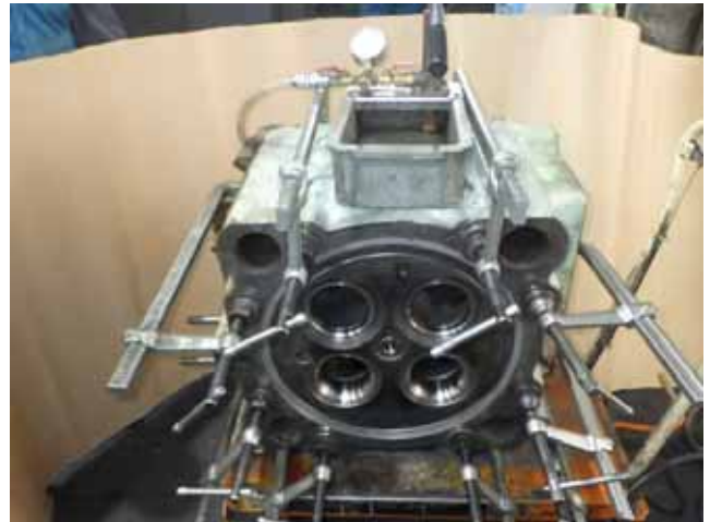
NO.3D509 Pressure test. 耐圧テスト
