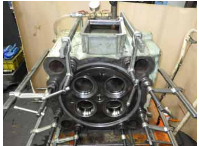
NO.3D508 Pressure test. 耐圧テスト
