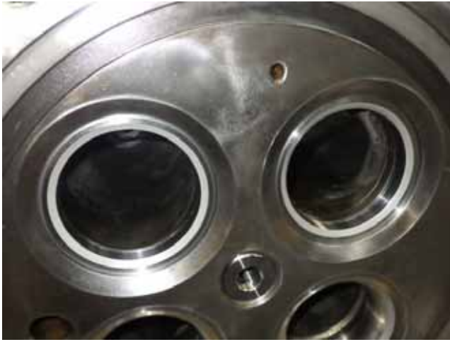
Intake valve seat lapping. 吸気弁座 当たり面摺り合わせ
