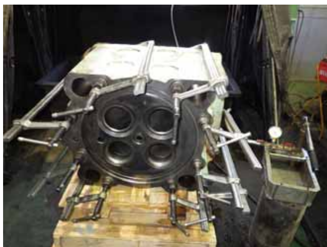
Pressure test. 耐圧テスト
