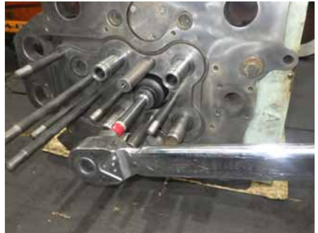
Tightening nozzle sleeve. ノズルスリーブ締め付け
