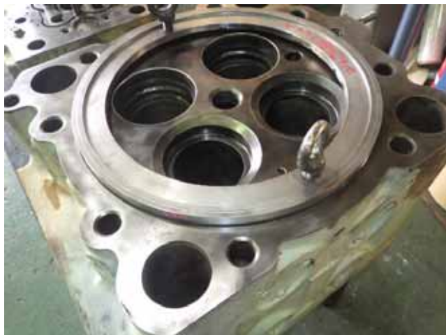
Packing fitting face lapping. パッキン当たり面 摺り合わせ
