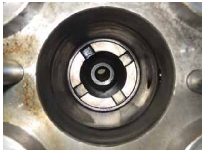
Exhaust valve seat no water leak. 排気弁座 水漏れ無し
