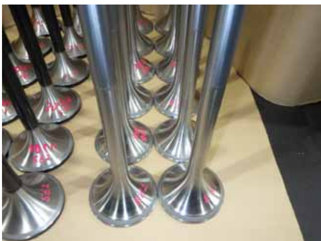
Exhaust valve lapping. 排気弁棒 当たり面摺り合わせ
