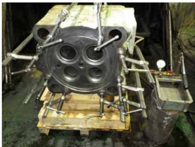
Pressure test. 耐圧テスト
