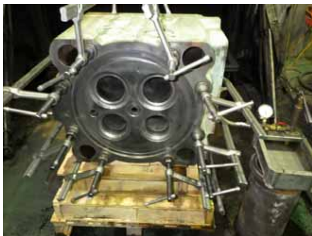
Pressure test. 耐圧テスト
