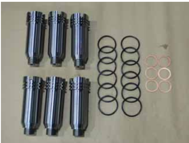
New nozzle sleeve, O-ring and packing. ノズルスリーブ、Oリング、パッキン新品
