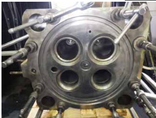
Pressure test. 耐圧テスト
