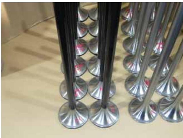
Intake valve lapping. 吸気弁棒 当たり面摺り合わせ
