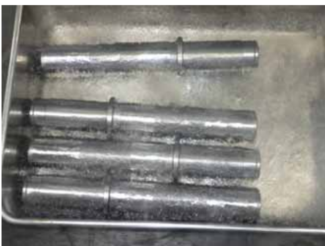
Cooling exhaust valve guide with liquid nitrogen. 排気弁ガイド 液体窒素にて冷却
