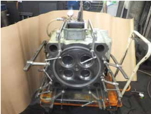
NO.3D711 Pressure test. 耐圧テスト
