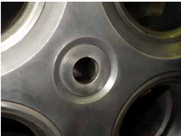
Nozzle sleeve no water leak. ノズルスリーブ 水漏れ無し
