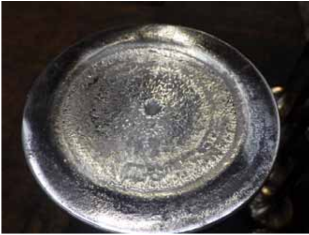
Combustion side corrosion. 燃烧面 腐蝕
