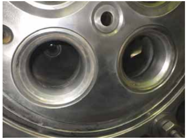
Exhaust valve seat no water leak. 排気弁座 水漏れ無し
