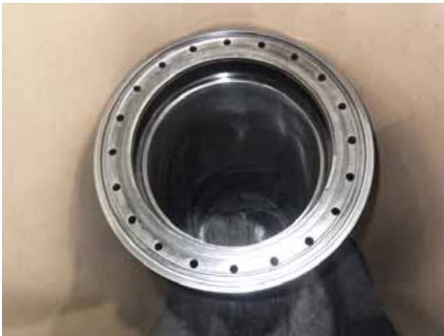
Finished liner honing. ホーニング加工完成
