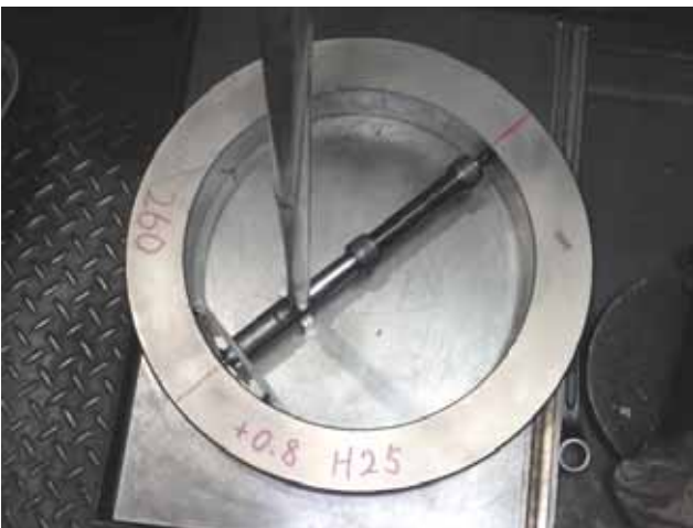
Bore gauge set up. 基準ゲージにて0 設定
