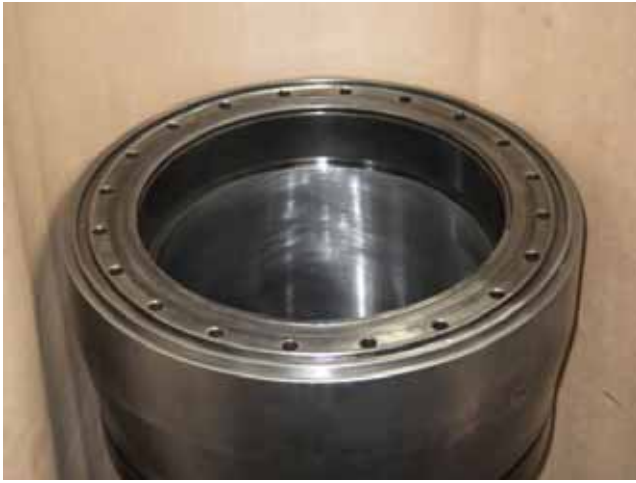
Finished liner honing. ホーニング加工完成
