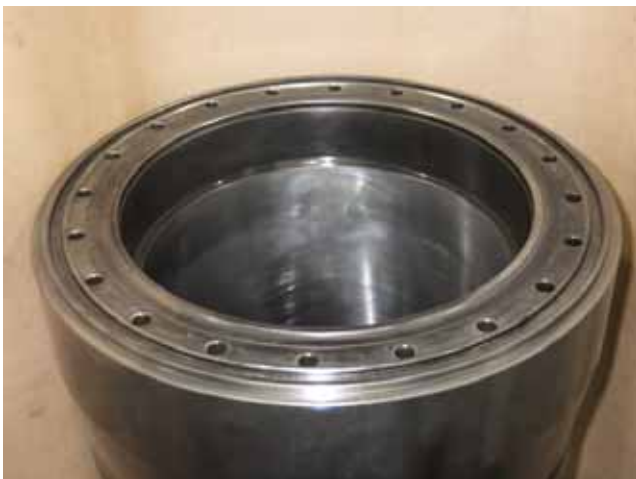
NO.®M216 Finished liner honing. ホーニング加工完成
