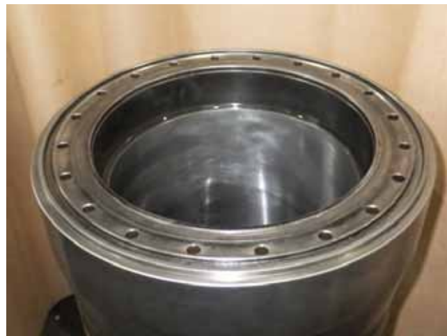
NO.®M210 Finished liner honing. ホーニング加工完成
