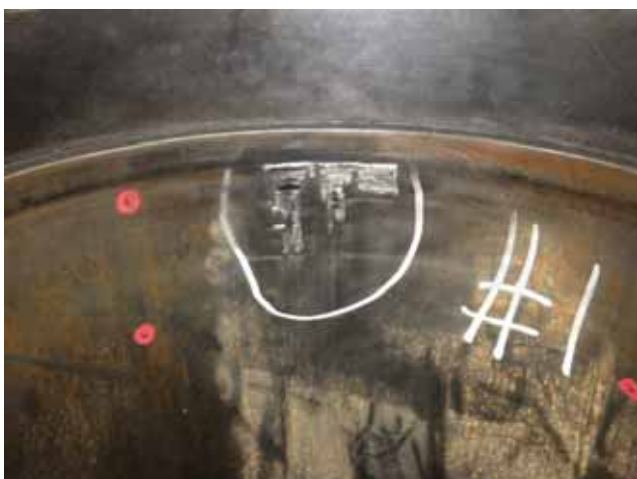
NO.ⓄM210 Blow by part laser welding. 吹き抜け傷部 レーザー溶接肉盛
