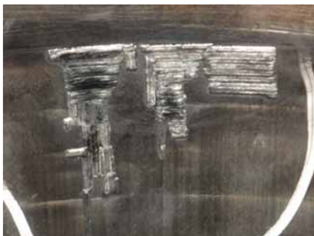
NO.ⓄM210 Blow by part laser welding. 吹き抜け傷部 レーザー溶接肉盛
