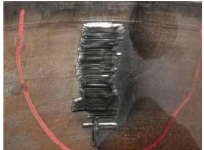
NO.ⓄM216 Blow by part laser welding. 吹き抜け傷部 レーザー溶接肉盛
