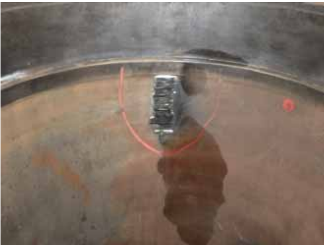
NO.ⓄM216 Blow by part laser welding. 吹き抜け傷部 レーザー溶接肉盛
