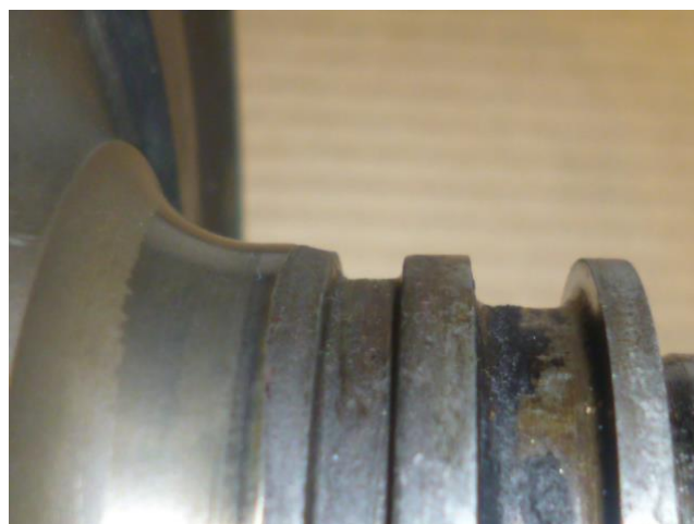
シーリング溝 溝幅 3.59 mm 基準 3.19 mm 限度 3.37 mm
