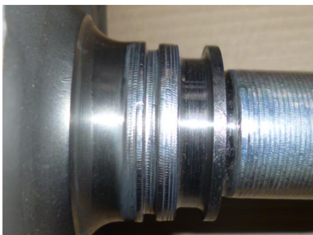
シールリング溝 レーザー溶接肉盛 [Seal ring groove laser beam welding.]
