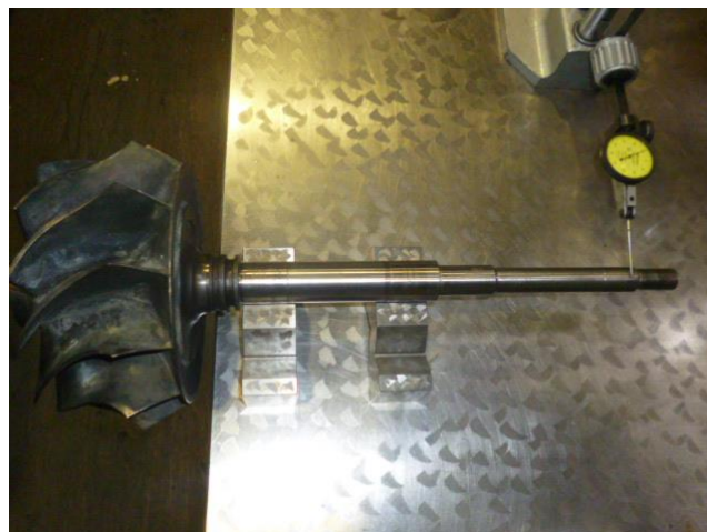
曲がり検査 0.01 mm 良好 [Bent inspection. 0.01 mm OK.]
