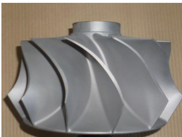
翼車ショットブラスト後 [After shot blast turbine blade.]
