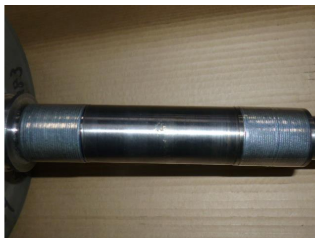
ジャーナル部 レーザー溶接肉盛 [Journal part laser welding.]
